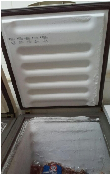
freezers acumulando gelo nas portas
